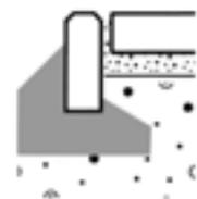
**entwässerungsrinnen //** Oberflächlich anfallendes Wasser muss auf möglichst kurzen Fließwegen zügig von der Oberfläche abgeleitet werden. Entwässerungsrinnen erhalten eine Längsneigung von mind. 0,5%. Die Elemente, z. B. Muldensteine, Rinnenplatten oder Pflastersteine, sind höhen- und fluchtgerecht auf ein Fundament aus Beton zu setzen und mit gebundenem Fugenmaterial zu verfugen. Entwässerungsrinnen sind mit Bewegungsfugen auszuführen.
